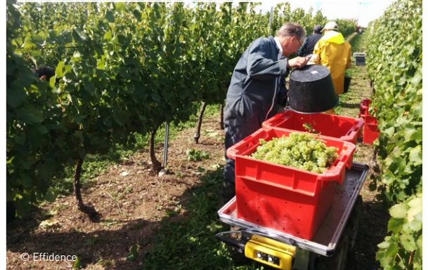
Véhicule de type « mule » suivant automatiquement une personne ou groupe de personnes, commercialisé par Effidence
